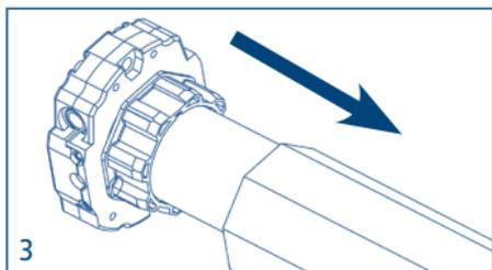
3. Den Motor vollständig in die Rolladenwelle oder Markisennutrohr einschieben.
