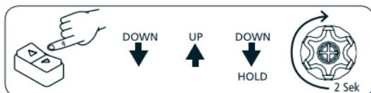
Die genannten Tasten schnell hintereinander drücken, und bei dem mit "HOLD" gekennzeichneten Schritt die Taste gedrückt halten, so dass überprüft wird, dass die Bestätigungsbewegung des Motors durchgeführt wird.
