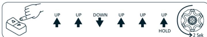
**Achtung!** Falls die Schaltwippe eine Stopp-Position hat, muss bei einer Wiederholung der Befehlsfolge (Up+Up/Down+Down) nach jeder Befehlsfolge die Stopp-Position angesteuert werden.
