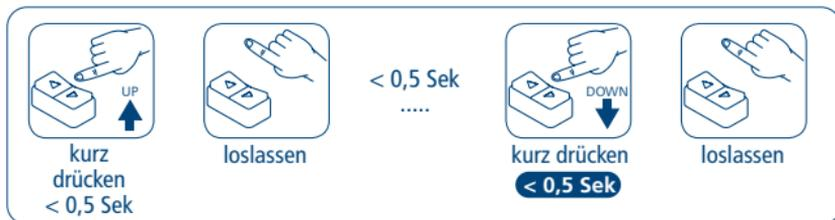
Der Motor kann über den drahtgebundenen Taster (weißer Draht), wie auf dieser Seite beschrieben, programmiert werden (DRAHTGEBUNDENE PROGRAMMIERUNG).
