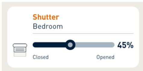
Durch Verschieben des Schiebereglers in der Schiebereglerleiste kann der Öffnungsgrad des Rollladens eingestellt werden.
