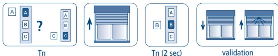
À ce moment, le sens de rotation est déterminé correctement. Il est possible de déconnecter le moteur et de terminer la mémorisation du fin de course inférieur sur le chantier. À la remise sous tension, le moteur se déplace normalement sans avoir à maintenir pressées les touches. La première fois que le moteur s'arrête sur la butée inférieure, cette position reste mémorisée automatiquement.
