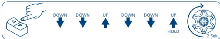
Das Löschen einer oder beider Endlagen hebt sich dadurch hervor, dass der Motor sich kurz bewegt, kurz stoppt, bevor er sich erneut bewegt. Dies bis beide Endlagen erneut einge­lernt sind.
