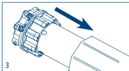
**Bem:** Bei Rundrohren muss der Antriebsadapter am Rohr befestigt werden. Diese Operation geht zu Lasten des Installateurs. Bei anderen Rohrprofilen ist die Befestigung optional, wird jedoch dringend empfohlen.
