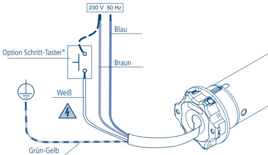
\* Die zusätzliche Montage des Schritttasters ist nicht zwingend, die Verbindung kann entweder mit der Fase (braunes Kabel) oder mit dem Nulleiter (blaues Kabel) erfolgen. Diese Taste ermöglicht den Motor im Schritt-Schritt Modus zu bedienen. (Auf, Stopp, Ab, Stopp, Auf, Stopp .....
