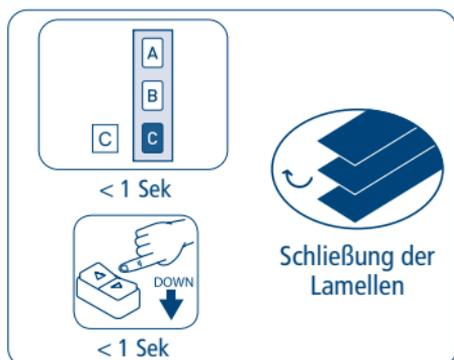
Wird eine Taste auf der Fernbedienung (A oder C) oder eine externe Taste (AUF oder AB) lange (> 1 Sek.) gedrückt, führt der Motor einen kurzen Impuls in die entsprechende Richtung aus und nach 1 Sekunde startet er kontinuierlich.
