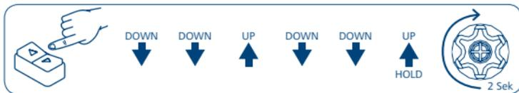
Das Löschen einer oder beider Endlagen hebt sich dadurch hervor, dass der Motor sich kurz bewegt, kurz stoppt, bevor er sich erneut bewegt. Dies bis beide Endlagen erneut eingelegt sind.
