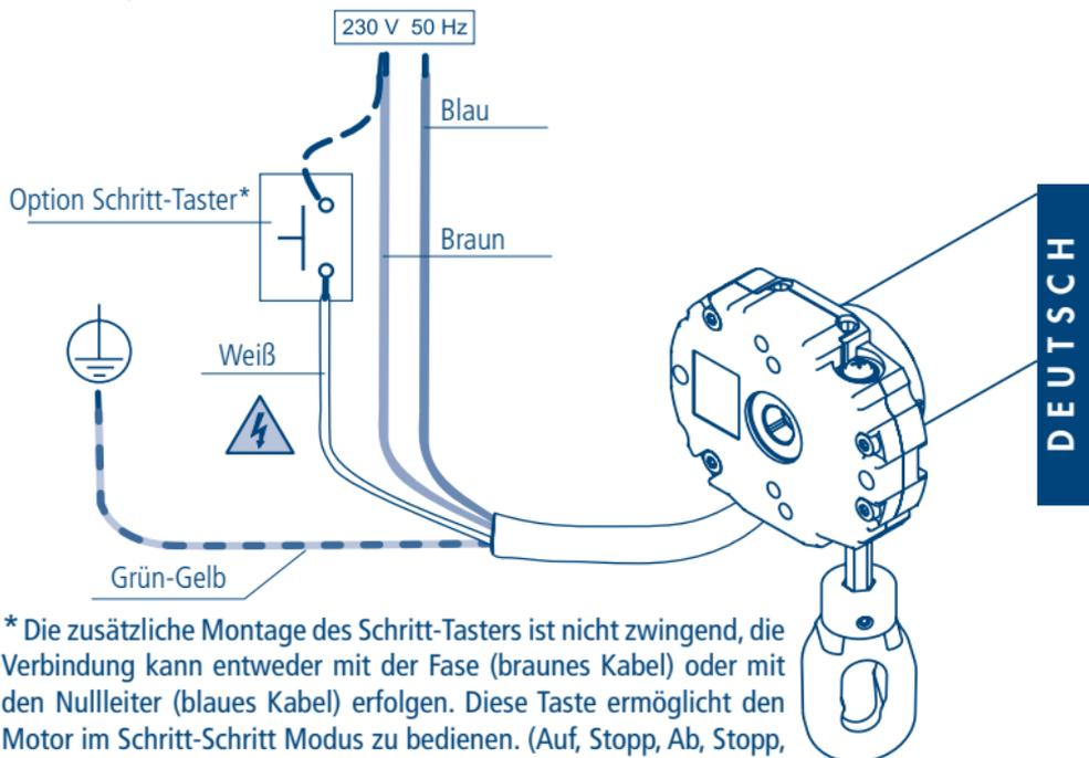
\* Die zusätzliche Montage des Schritt-Tasters ist nicht zwingend, die Verbindung kann entweder mit der Fase (braunes Kabel) oder mit den Nullleiter (blaues Kabel) erfolgen. Diese Taste ermöglicht den Motor im Schritt-Schritt Modus zu bedienen. (Auf, Stopp, Ab, Stopp, Auf, Stopp ...)
