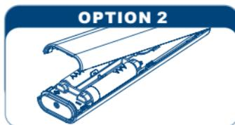
Eine Batterie kurz herausnehmen und wieder einsetzen
