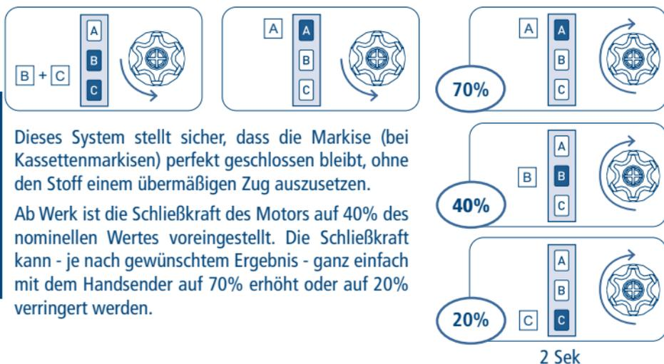
Dieses System stellt sicher, dass die Markise (bei Kassettenmarkisen) perfekt geschlossen bleibt, ohne den Stoff einem übermäßigen Zug auszusetzen.
