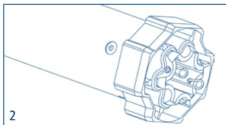
2. Den Antriebsadapter bis zum Einrasten der Feder aufstecken.
