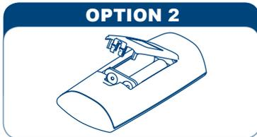
Eine Batterie kurz herausnehmen und wieder einsetzen
