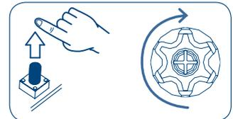
Durch Umhängen des **braunen** und **schwarzen** Kabels des Motors auf den Klemmen der Steuerung, wird ebenfalls eine Änderung der Drehrichtung hervorgerufen.
