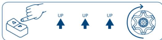
Bei positiv abgeschlossener Befehlsfolge, wie auf obigem Beispiel dargestellt, führt der Motor eine lange Einzeldrehung durch. Führt der Motor keine Drehung durch, bedeutet dies, dass die Befehlsfolge fehlgeschlagen ist. In diesem Fall muss die Befehlsfolge vom Anfang an wiederholt werden.
