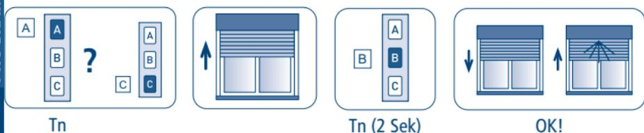
Nun ist die Drehrichtung erkannt worden. Der Motor kann vom Netz getrennt werden. Wie bereits erwähnt wird die untere Endlage nach Auflaufen auf die untere Endlage automatisch programmiert.
