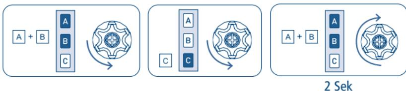
Durch das vollständige Löschen der Endanschläge wird der kurze Impuls zur Einstellung der Neigung der Lamellen automatisch zurückgesetzt.
