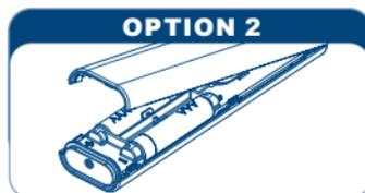
Eine Batterie kurz herausnehmen und wieder einsetzen
