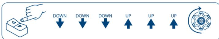
Diese Folge versetzt den Motor in den Betriebsmodus "Bediener anwesend". Dies dient dazu die Mittelposition genau nach Wunsch einstellen zu können. Um die gewählte Position zu bestätigen:
