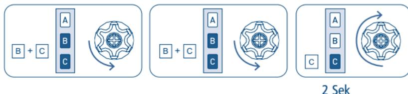
Warten Sie am Ende der Abfolge, bis sich der Rollladen zur Gänze geschlossen hat. Ab diesem Zeitpunkt bewegt sich der Motor in "Bediener anwesend" Modus. Dies ermöglicht es, die Einstellung der Öffnungsposition präzise vorzunehmen.
